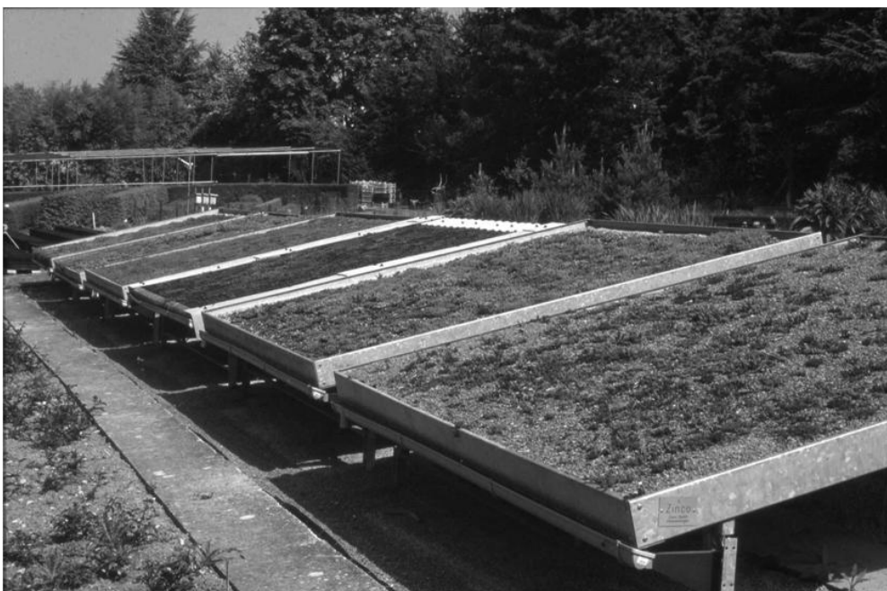
4. ábra. Extenzív zöldtető rendszerek összehasonlító bemutatója Németországban.
